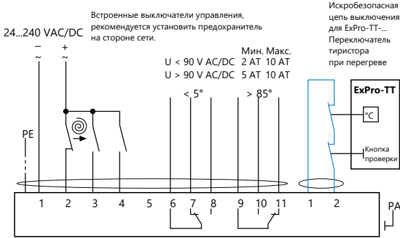
Картинка 23: SB7.3 — тип кабеля 10+PE, диаметр кабеля 9,4 мм
