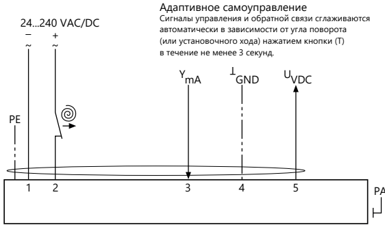
Картинка 19: SB6.1 — тип кабеля 5+PE, диаметр кабеля 7,5 мм
