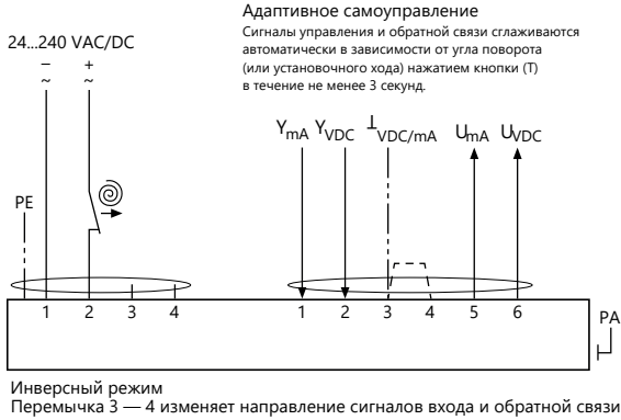
Картинка 13: SB4.1 — тип кабеля 4+PE, диаметр кабеля 7,2 мм/Тип кабеля 6, диаметр кабеля 7,4 мм
