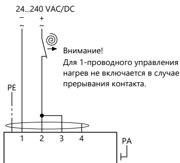
Картинка 7: SB2.3 — тип кабеля 4+PE, диаметр кабеля 7,2 мм
