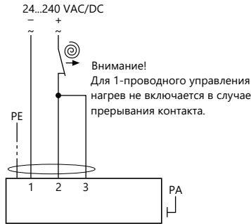
Картинка 9: SB2.5 — тип кабеля 3+PE, диаметр кабеля 6 мм
